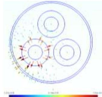
**Figure 46 : current density A/m<sup>2</sup>**
