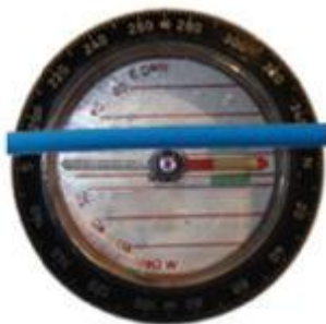
Sans courant dans le fil électrique, l'aiguille rouge de la boussole indique le Nord
