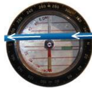
Le courant circule de droite à gauche. La boussole en perd le Nord !
