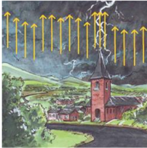
Elektrisch veld dat 15 tot 20 kV/m kan bereiken
