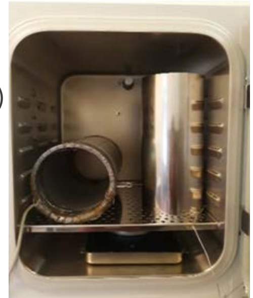
Système d'exposition (à gauche) et du système de protection (à droite) à l'intérieur de l'incubateur.
