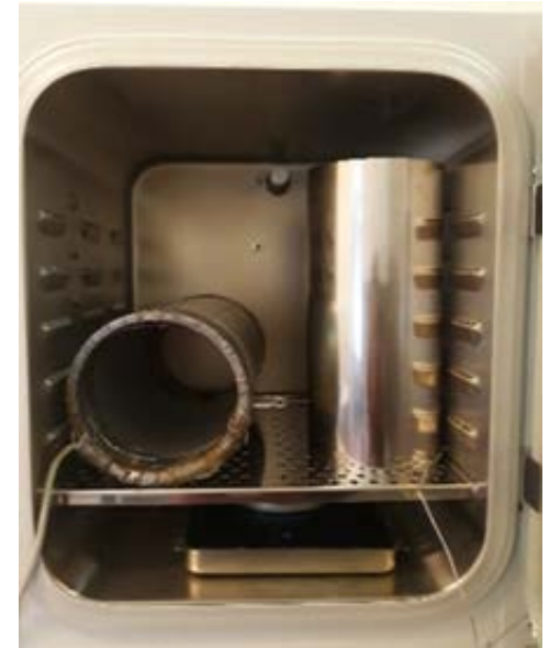
Foto van het belichtingssysteem (links) en het afschermingssysteem (rechts) in de incubator
